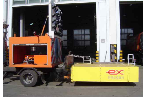
<그림 16> TMA (Truck Mounted Attenuator) : 트럭장착용 충격흡수장치
